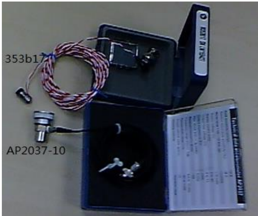
图 3 PCB.353B17（约 1.7 克）和 AP2307-10（约 10 克，磁座 16 克）的实物比较
